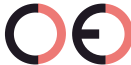
Falsche CE-Kennzeichnung (zu großer Zwischenraum)
